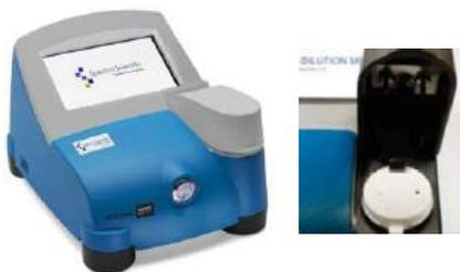
Прибор для определения уровня pH в охлаждающей жидкости. Устройство дает более точное значение уровня pH антифриза, чем используемые на данный момент тестовые полоски. Уровень pH показывает среду антифриза: до тех пор, пока она щелочная, антифриз защищает систему охлаждения от коррозии и нейтрализует кислоты.
